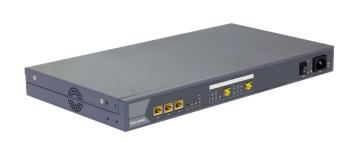
台联SP 1700T E1/T1 ISDN SIP路由中继语音网关,可将传统ISDN 网路中E1/T1电路中提取语音流,并封装为SIP格式协议,可替代原有由ISDN、SDH等传统TDM时隙传送网的传送方式,改由现今最普及的以太网路上传送语音封包及进行语音交换等任务。
